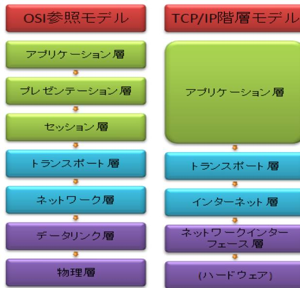
図 2.3: OSI 参照モデルと TCP/IP の関係
